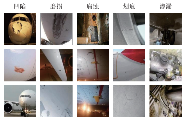
图1 飞机损伤缺陷
